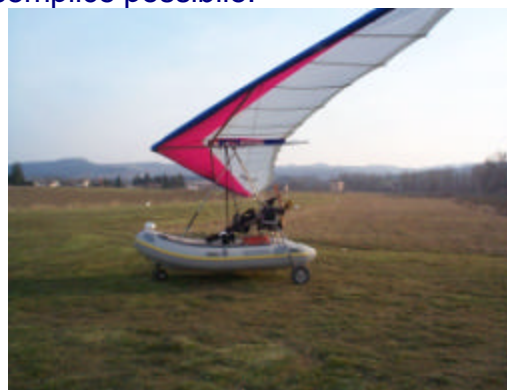
Peso totale del carrello di atterraggio 23kg Carrello di atterraggio inTitanio TiGR5
