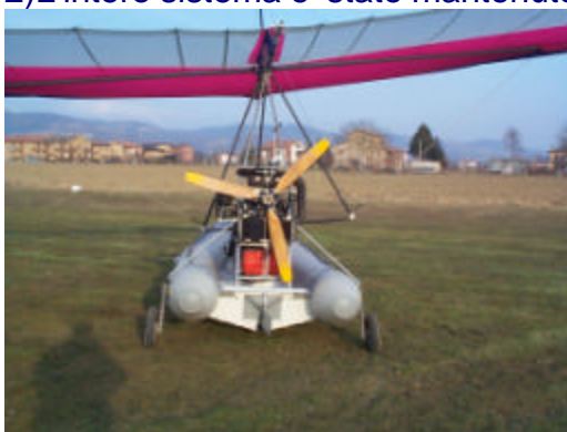
Peso totale del carrello di atterraggio 23kg Carrello di atterraggio inTitanio TiGR5
